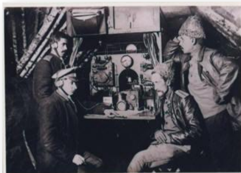
Военно-полевая искровая радиостанция 1910 г
