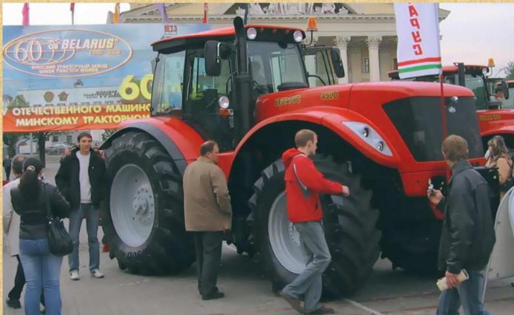
**Оснащён двигателем 6063НК33 (Детройт) с турбонаддувом и охлаждением наддувочного воздуха, электронное управление впрыском воздуха. Мощность двигателя, кВт (л.с.) 336 (450).**
