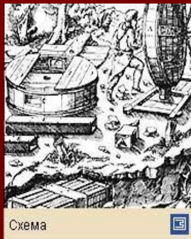
Старинная гравюра изображающая Механизм для проветривания шахт 15 век
