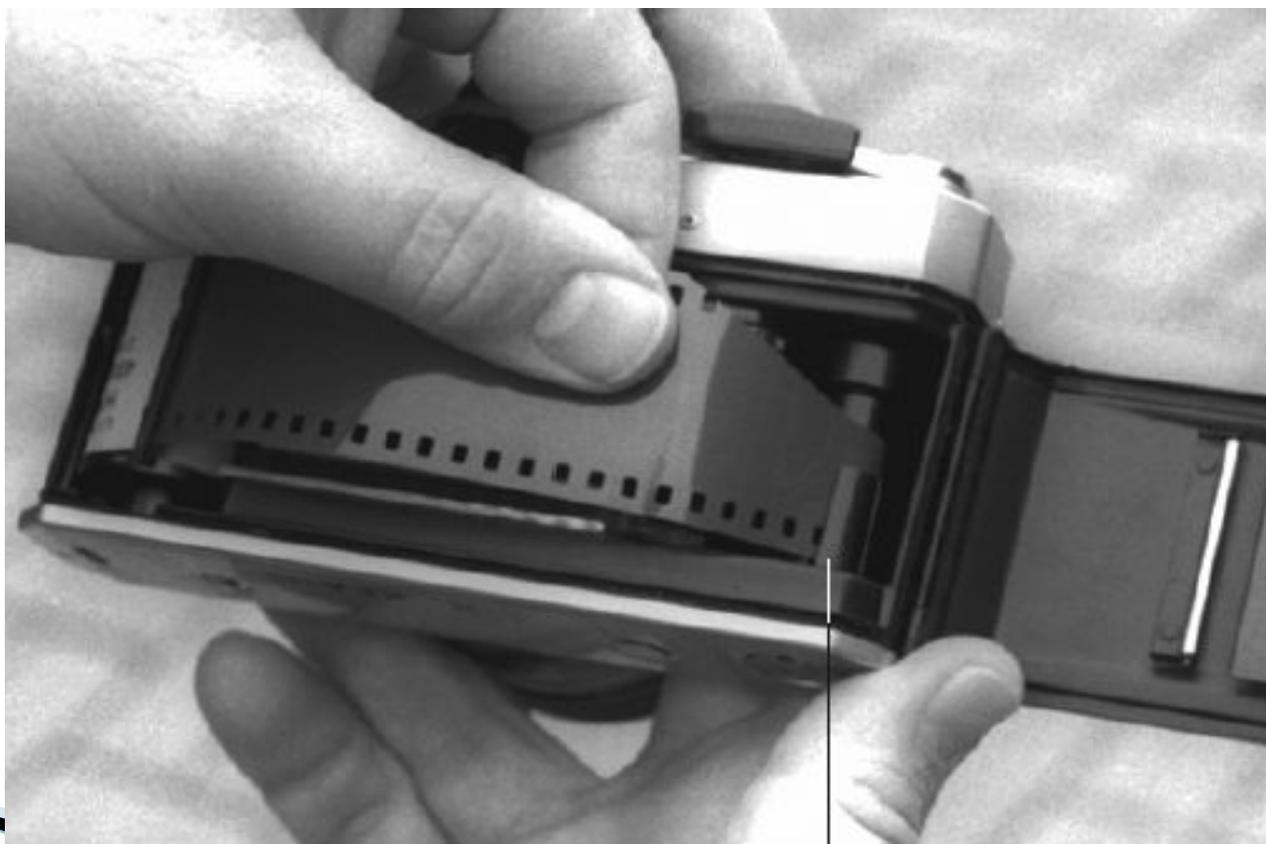
**Отснятую плёнку необходимо было проявить. Для чего в полной темноте её наматывали на специальную спираль и помещали внутрь светонепроницаемого бачка (частью которого спираль и являлась).**
