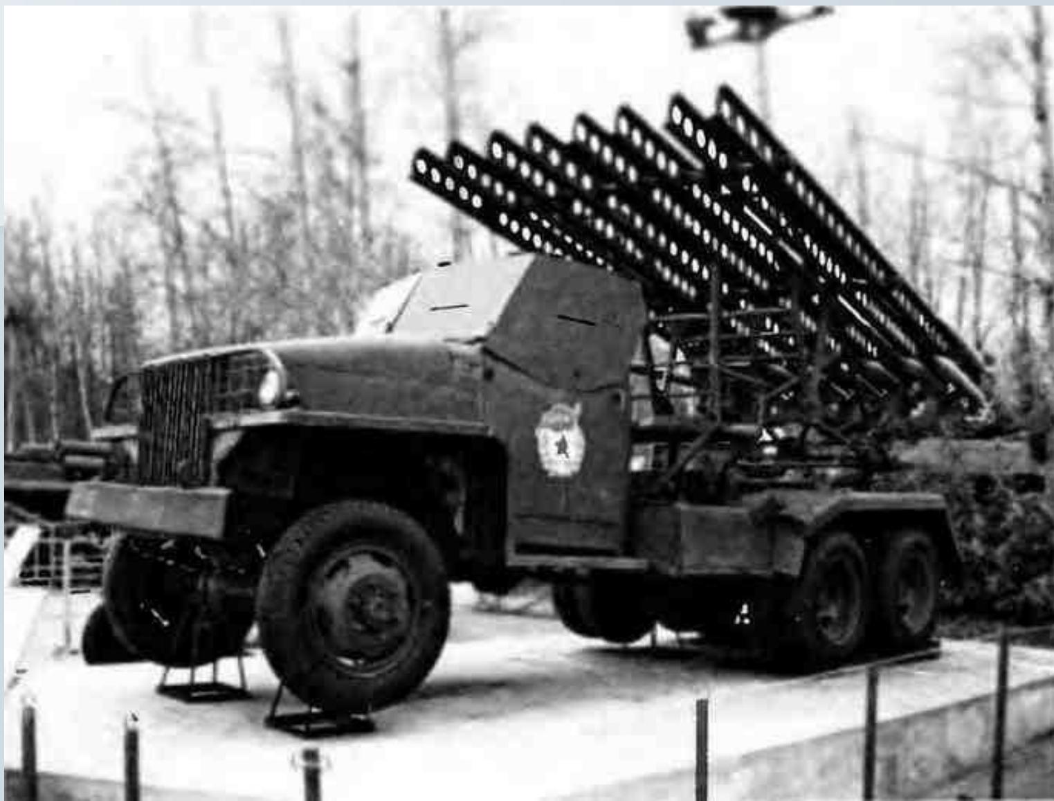
Реактивная установка БМ-13 на шасси автомобиля «Студебеккер»
