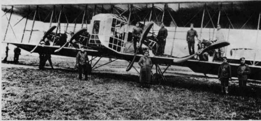
Тяжёлый бомбардировщик «Илья Муромец», конструктор Сикорский
