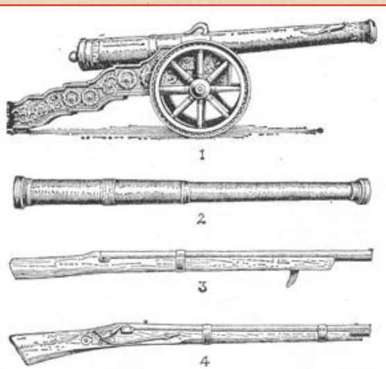
Пищали: 1 — осадная на декоративном лафете 16 в.; 2 — бронзовая конца 15 в.; 3 — «затинная» (крепостная) сер. 16 в.; 4 — «завесная» (носившаяся за плечом на ремне) с фитильным замком конца 16 в.
