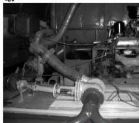
Рис. 48 ТЭ-16 УИП. Завод «Спецмаш». Автомобильный двигатель для привода пожарного насоса.
