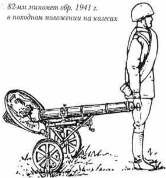
82-мм миномет обр. 1943 г. в походном положении на колесах
