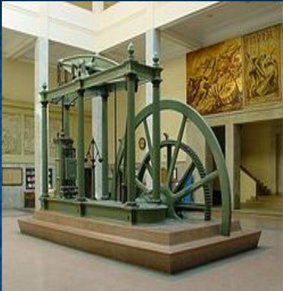
Паровая машина Дж. Уатта
