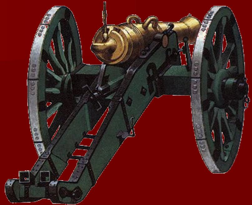
Единорог- короче пушки (от 10 до 11 калибров), имеет коническую камору и служит для стрельбы по большей части гранатами и бомбами, а также картечью, брандскугелями, каркасами и светящими ядрами. Эти орудия были специфическими для русской артиллерии.
