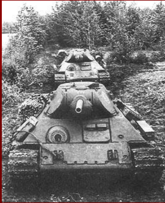
Т-34 с дополнительным бронированием, установленным на заводе №29, выдвигаются к фронту. Ленинградский фронт. 1942.
