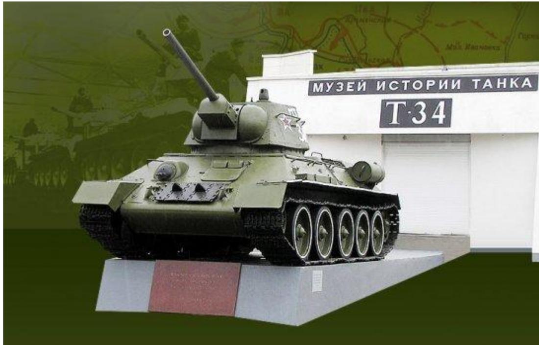
Т-34-85 — [советский средний танк](#) периода [Великой Отечественной войны](#). Создан в 1943 году на базе [Т-34-76](#), с использованием элементов конструкции опытного танка [Т-43](#). Отличался от своего предшественника значительно более мощной 85-мм [пушкой](#), установленной в новой, более просторной, трёхместной [башне](#) и рядом мелких доработок.
