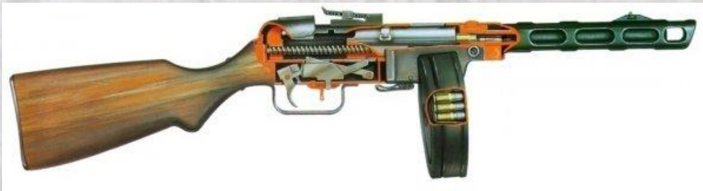
Схема устройства ППШ-41 с секторным прицелом
