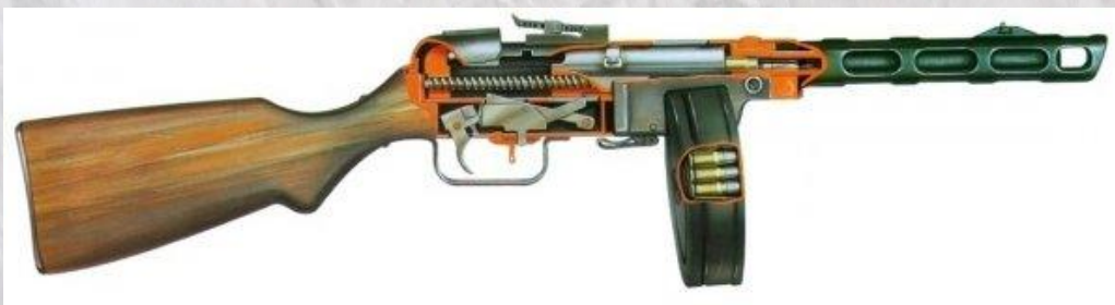
Схема устройства ППШ-41 с секторным прицелом
