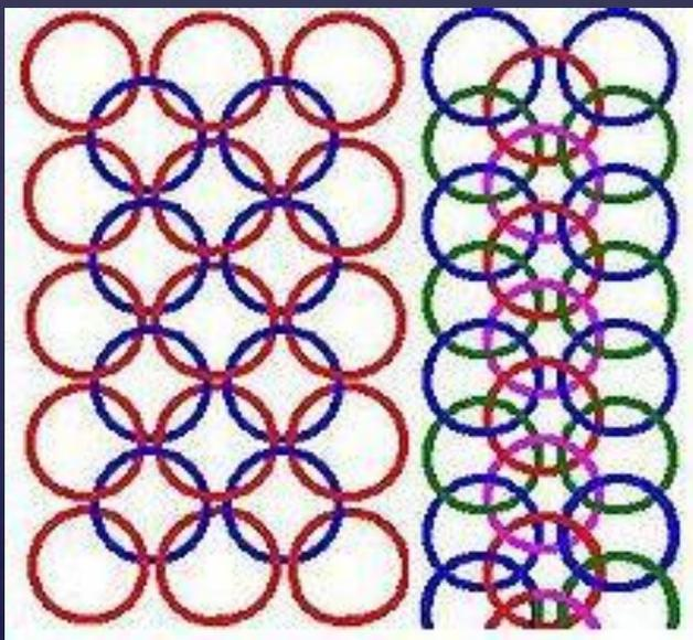
Сплетение состояло из целых колец и колец на заклепках или штифтах, т. е. половина колец были целые, а половина разводные, которые после сборки соединялись заклепкой или штифтом. Каждое кольцо охватывало четыре разъемных, а разъемное - четыре целых. Кольчуга делалась из железа. Обычная кольчуга на средний рост состояла примерно из 18-20 тыс. колец
