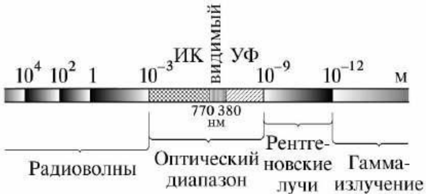
Рис.1.1.1. Шкала электромагнитных волн
