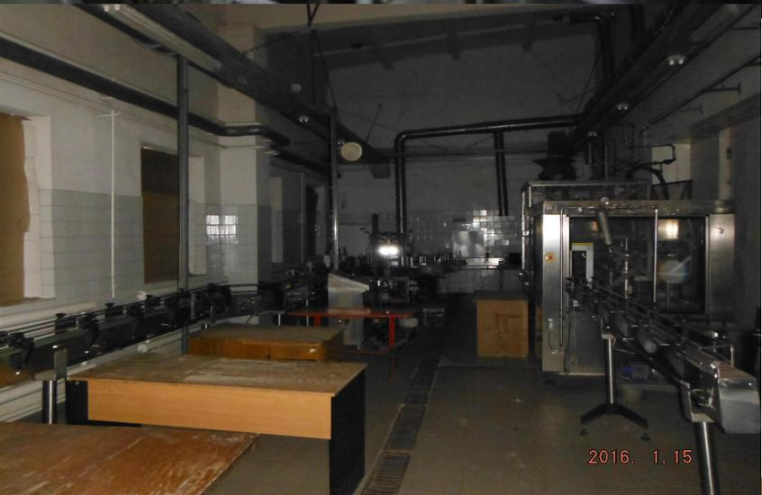
Техническое состояние оборудования по фотографиям выглядит удовлетворительным, о работоспособности судить можно только после запуска оборудования и проверки его работоспособности и производительности согласно паспортным данным. Отсутствует техническая документация, рабочие проекты, разрешение на ввод в эксплуатацию электроустановок, паспорта на оборудование.
