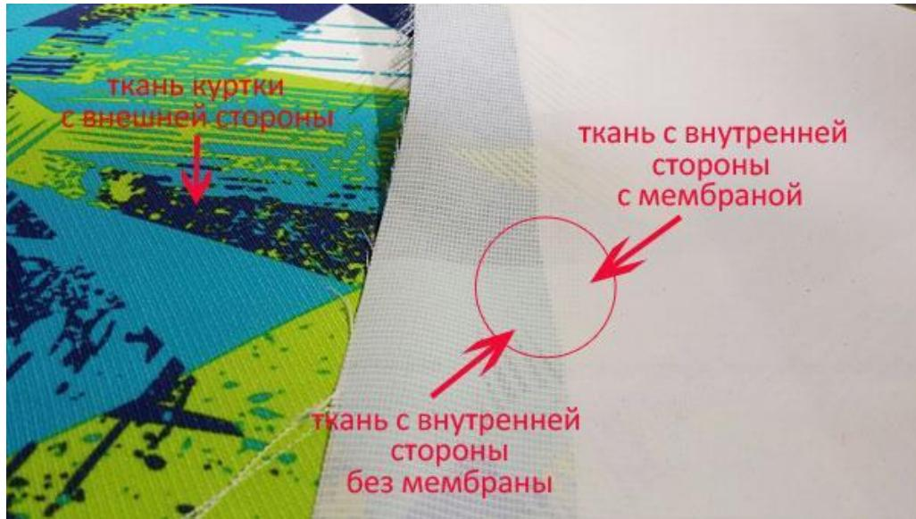
**Мембрана** — это слой синтетического материала (полиуретан), который наносится на внутреннюю поверхность ткани куртки. Технически мембрана - это что-то вроде пленки особой структуры, а мембранный ткань — это материя, в структуре которой присутствует эта самая специальная пленка.
