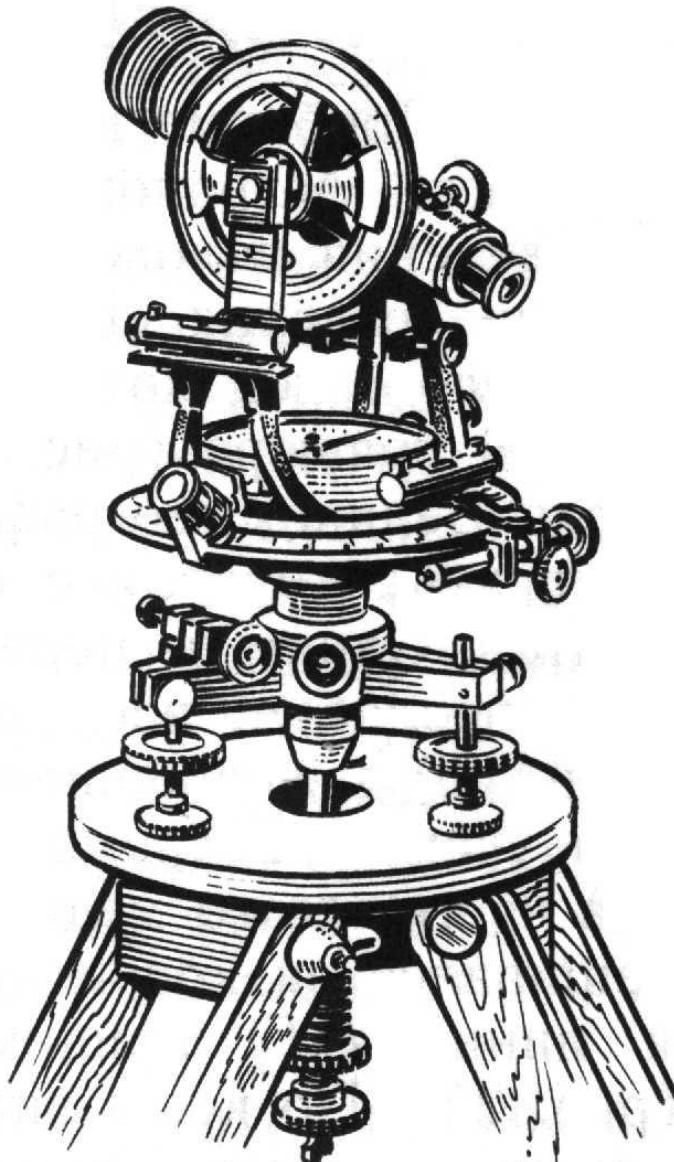
Наиболее совершенным угловым инструментом, применяющимся в настоящее время для выполнения геодезических работ, является теодолит, состоящий из двух лимбов, расположенных в вертикальной и горизонтальной плоскостях, что позволяет измерять вертикальные и горизонтальные углы одновременно. На вертикальном лимбе имеется зрительная труба, с помощью которой алидады вертикального и горизонтального лимбов наводятся на объект наблюдения. Точность измерения углов при этом составляет доли минуты.
