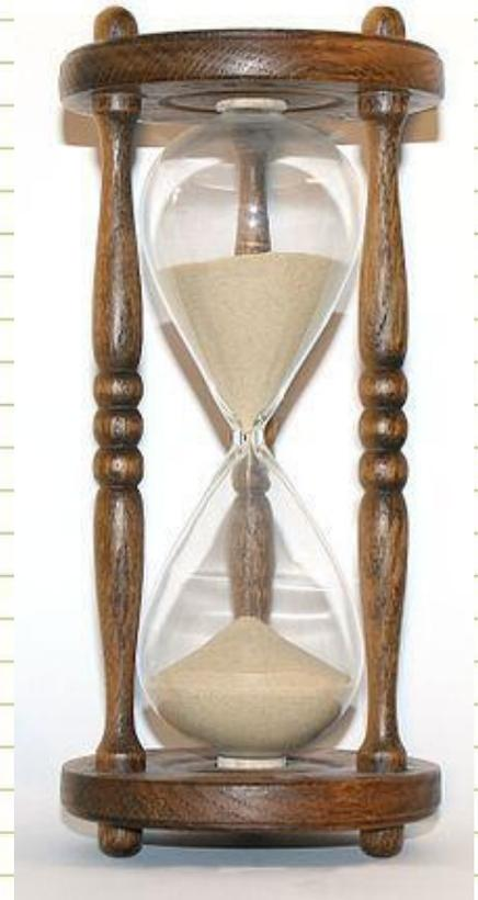
Песочные часы – один из самых древних приборов для определения времени. Они состоят из двух грушевидных емкостей, соединенных между собой узкими концами.
