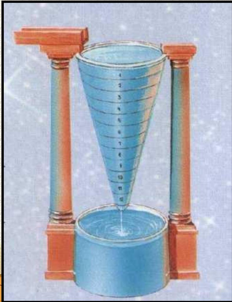
Водяные часы – это сосуд, из которого через дырочку постоянно вытекает вся вода. Потом нужно снова наполнять сосуд. Количество воды было строго отмерено. Это и позволяло определять время.
