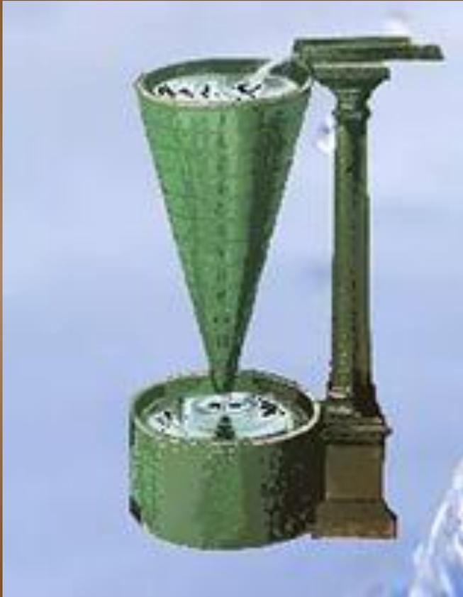
Водяные часы представляли собой сосуд цилиндрической формы, из которого истекала по каплям вода. Время определялось по количеству истекшей воды. Такие часы были распространены в Египте, Вавилоне, Риме. Однако существовала и другая разновидность водяных часов, которая была распространена в странах Азии - плавающий сосуд наполнялся водой, которая поступала через небольшое отверстие.
