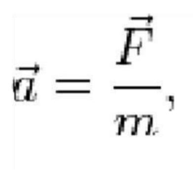
В инерциальной системе отсчёта ускорение, которое получает материальная точка с постоянной массой, прямо пропорционально равнодействующей всех приложенных к ней сил и обратно пропорционально её массе. Где а ускорение материальной точки; F равнодействующая всех сил, приложенных к материальной точке; т масса материальной точки.
