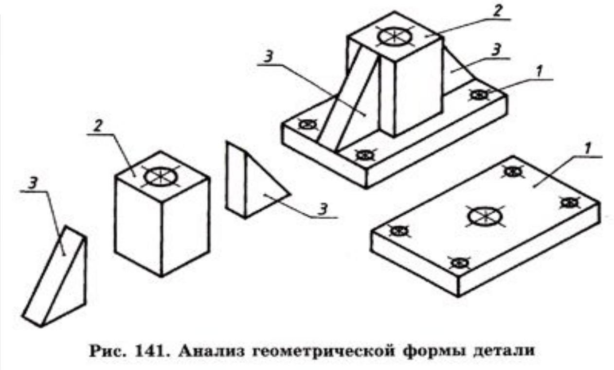
Рис. 141. Анализ геометрической формы детали
