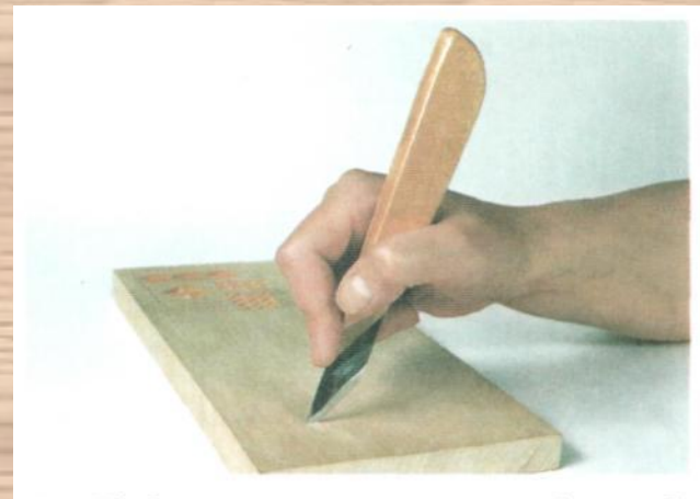
При резьбе на себя (способ 2)
