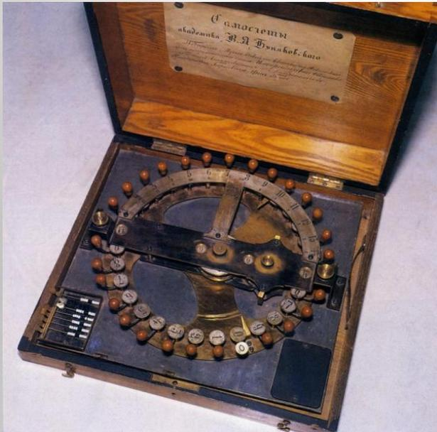
**Самосчёты Буныаковского** — вычислительный механизм, основанный на принципе действия русских счётов. Прибор удобен исключительно для сложения большого количества небольших чисел.
