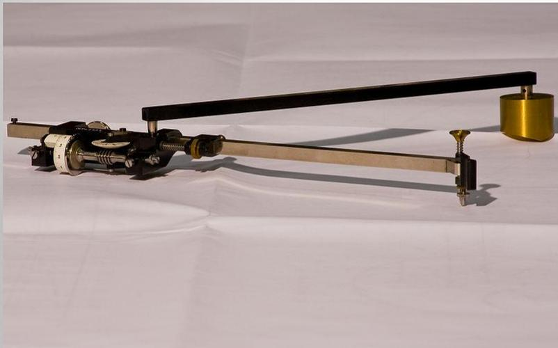
**Планиметр** - прибор, служащий для простого механического определения площадей замкнутых контуров, прорисованных на плоской поверхности.
