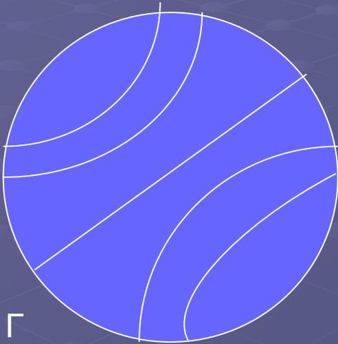
Точки – обычные точки, лежащие внутри окружности  $\Gamma$  (абсолюта), прямые – дуги окружностей, перпендикулярные абсолюту, а также диаметры окружности  $\Gamma$  («окружности бесконечно большого радиуса»).
