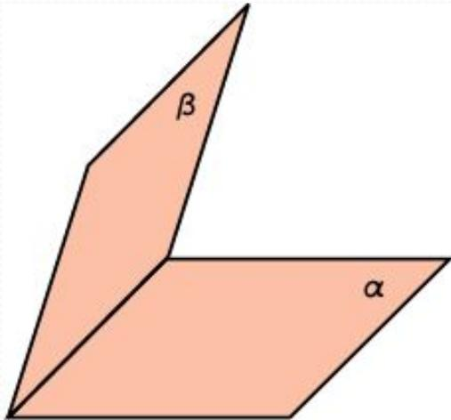
Двугранным углом называется фигура, образованная двумя полуплоскостями с общей граничной прямой.
