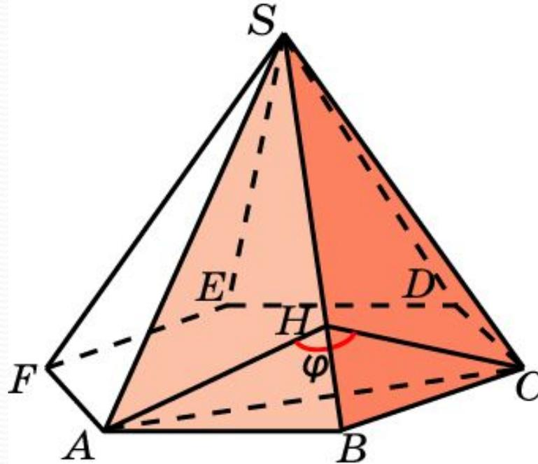
**Решение:** В треугольниках  $SAB$  и  $SBC$  опустим высоты  $AH$  и  $CH$  на сторону  $SB$ . Искомым линейным углом  $\varphi$  является угол  $AHC$ . В прямоугольном треугольнике  $AHC$  имеем:  $AC = \sqrt{3}$ ,  $AH = CH = \frac{\sqrt{15}}{4}$ . По теореме косинусов находим  $\cos \varphi = -\frac{3}{5}$ .
