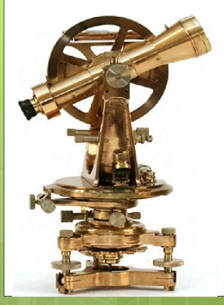
Теодолит оптический- это прибор для измерения как горизонтальных, так и вертикальных углов на местности. Этот прибор в своем развитии прошел длительный путь и вобрал в себя принципы действия таких приборов как гномоны, параллактические линейки, армиллы, астролябии, квадранты и другие.
