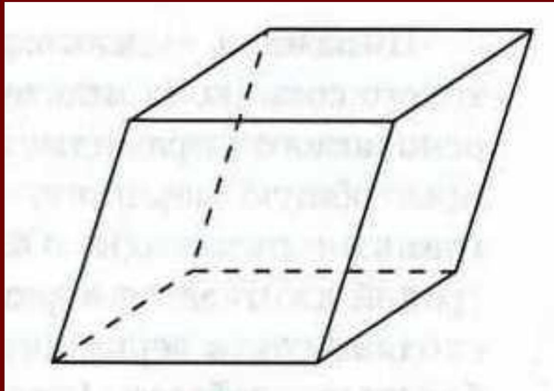
При изображении куба плоскость изображений обычно выбирается параллельной одной из его граней. В этом случае две грани куба, параллельные плоскости изображений (передняя и задняя), изображаются равными квадратами. Остальные грани куба изображаются параллелограммами.
