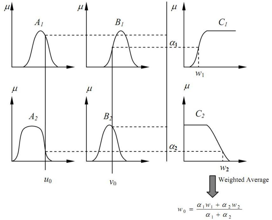
Данная система использует свой специфический метод дефаззификации, применение которого возможно исключительно для монотонных функций принадлежности.
