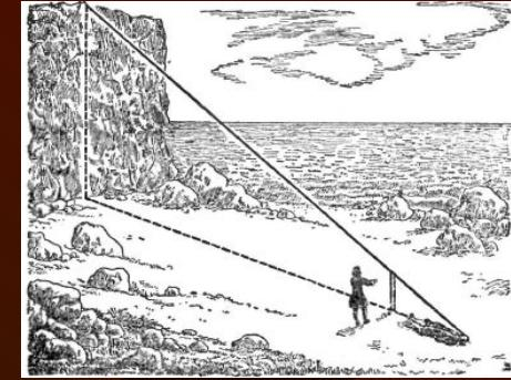
«- если мы измерим два первых расстояния, то, зная высоту шеста, сможем вычислить четвертый, неизвестный член пропорции, т. е. высоту стены.
