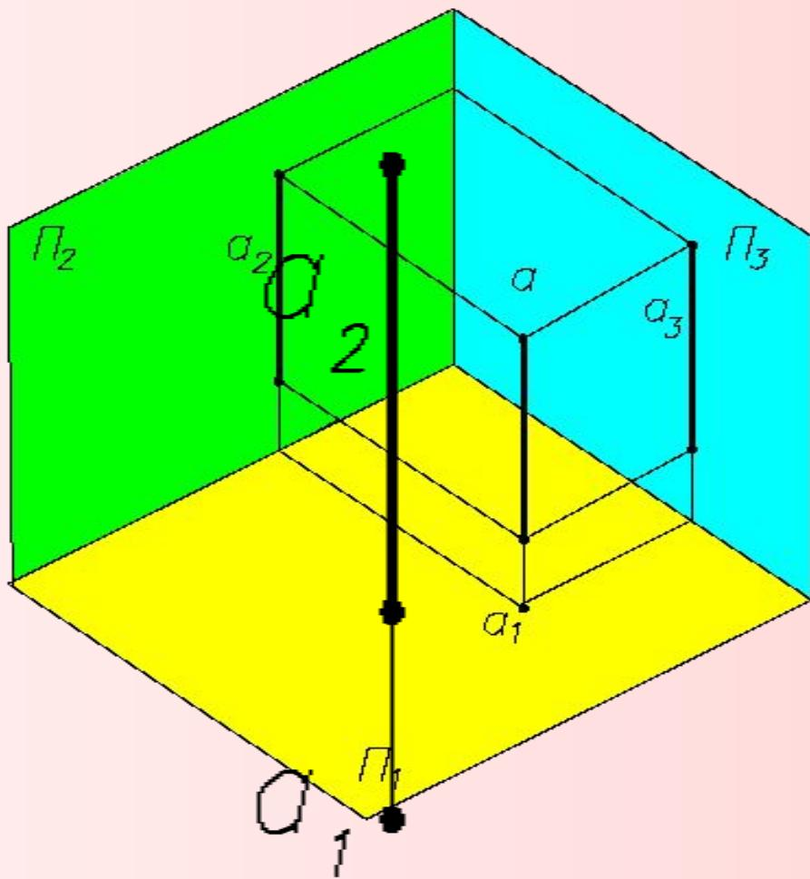
Горизонтально-проецирующая прямая – линия, перпендикулярная горизонтальной плоскости проекций.
