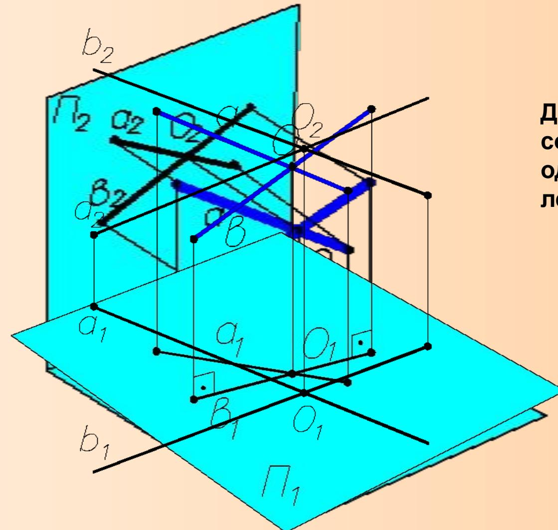
Две прямые пересекаются между собой, если точки пересечения одноименных проекций прямых лежат на одной линии связи .
