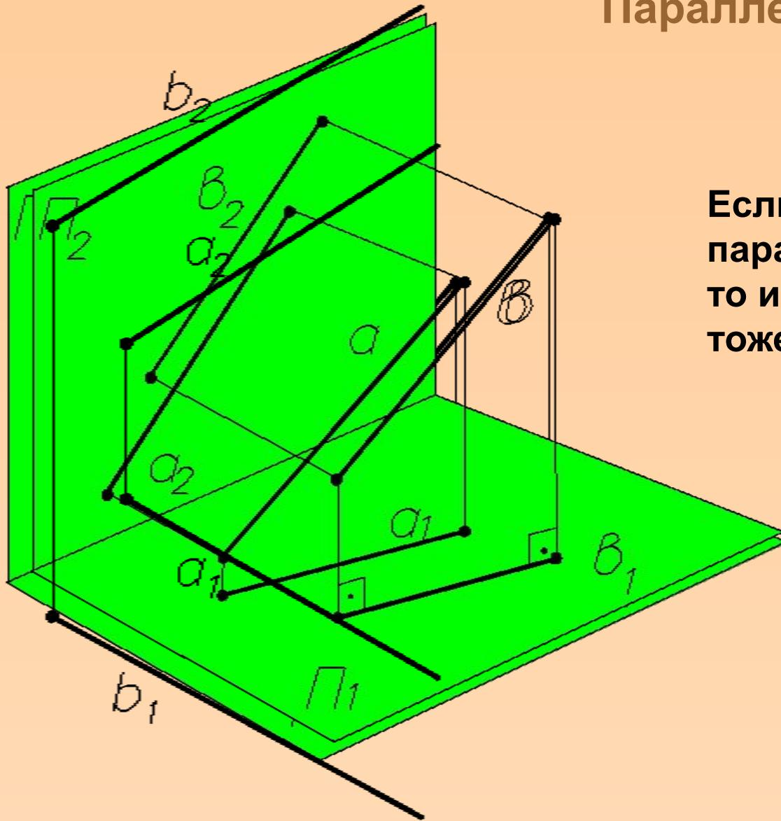
Если две прямые параллельны между собой, то их одноименные проекции тоже параллельны.
