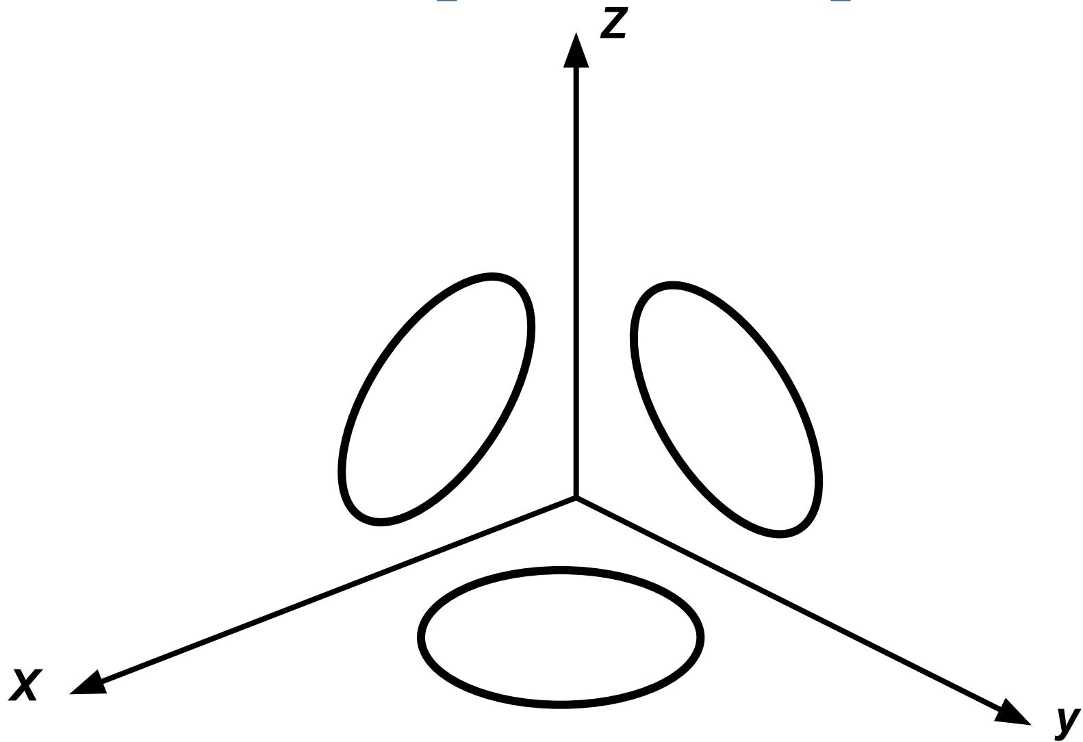
Построение овала в горизонтальной плоскости проекции
