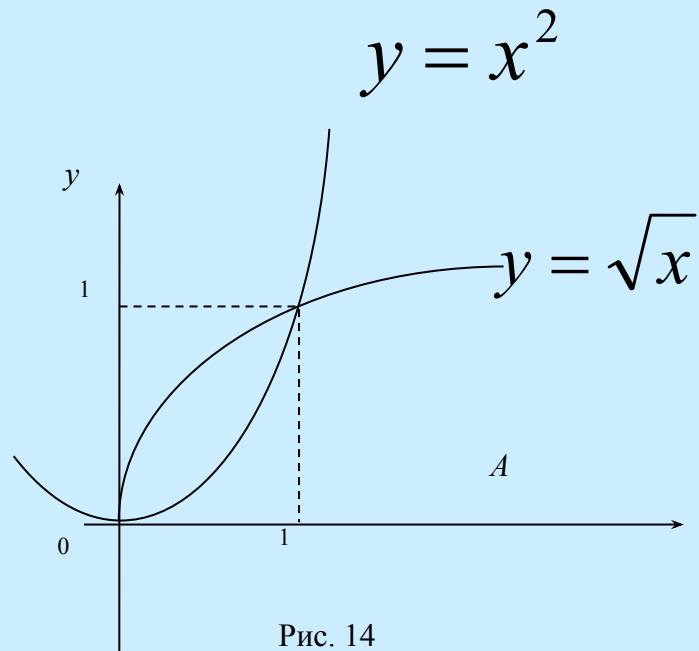
Искомый объем можно найти как разность объемов, полученных вращением вокруг оси Ох криволинейных трапеций, ограниченных линиями  $y = \sqrt{x}$  и  $y = x^2$
