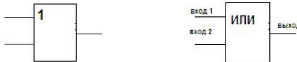
Если хотя бы на один вход поступает сигнал 1, то на выходе будет сигнал 1.
