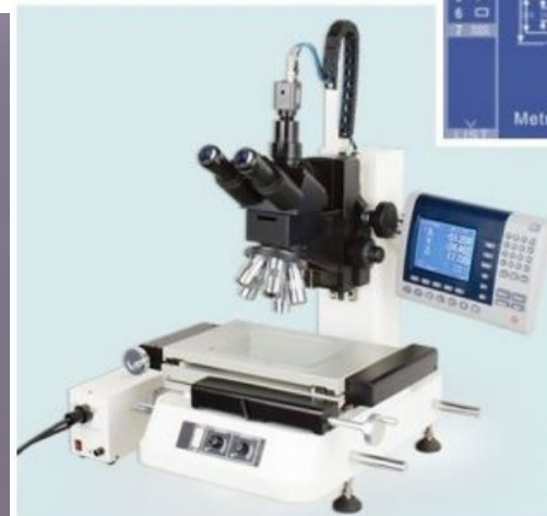
Бесконтактное измерение резьбы микроскопом
