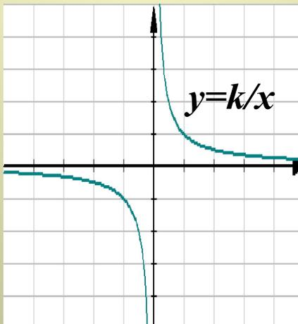
график нечетной функции симметричен относительно начала координат.
