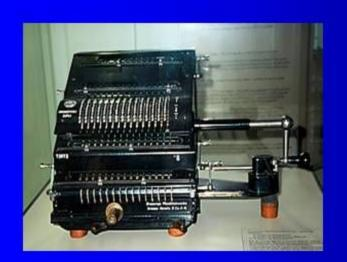
Механические счетные машины - АРИФМОМЕТРЫ - с видоизмененными "колесами Лейбница" использовались до середины ХХ столетия, пока не были вытеснены электрическими цифровыми вычислителями, а в последствии современными электронными калькуляторами.
