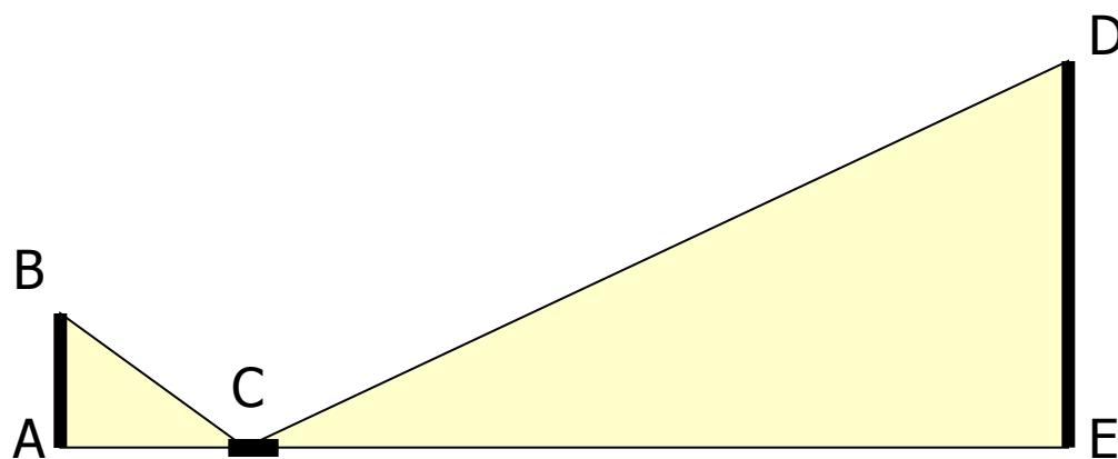
Луч света DC, отражаясь от лужи C, попадает в глаз человека В. По законам физики угол DCE равен углу BCA. Из подобия треугольников ABC и EDC выразим длину отрезка DE:
