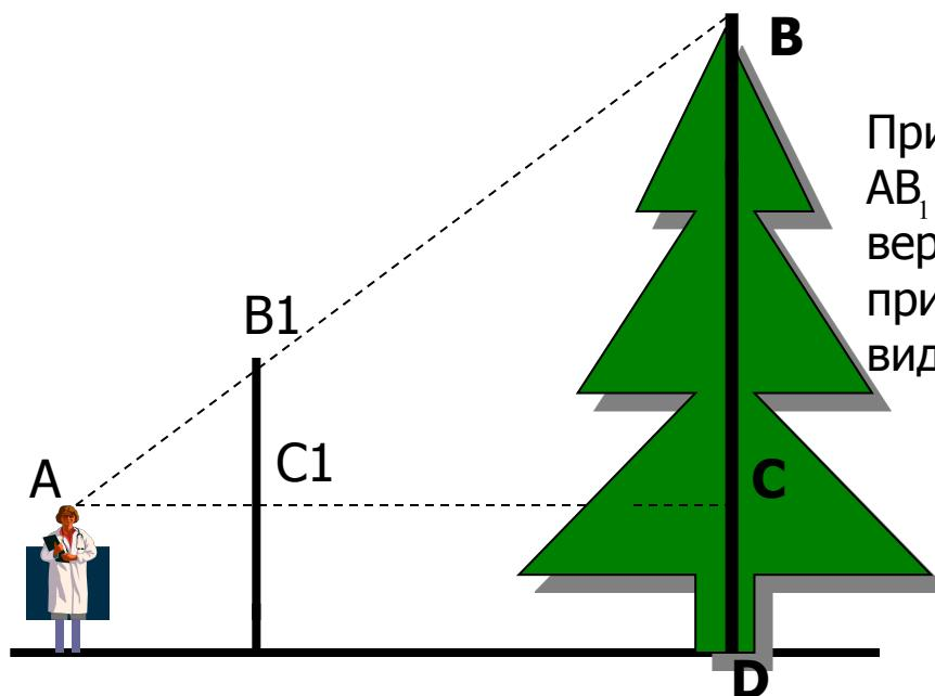
Приготовить прямоугольный треугольник  $AB_1C_1$  с углом  $A = 45^\circ$  и, держа его вертикально, отойти на такое расстояние, при котором, глядя вдоль гипотенузы  $AB_1$ , видна верхушка дерева В.
