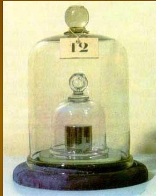
Прототип эталона представляет собой платиновую цилиндрическую гирю высотой и диаметром 39 мм.
