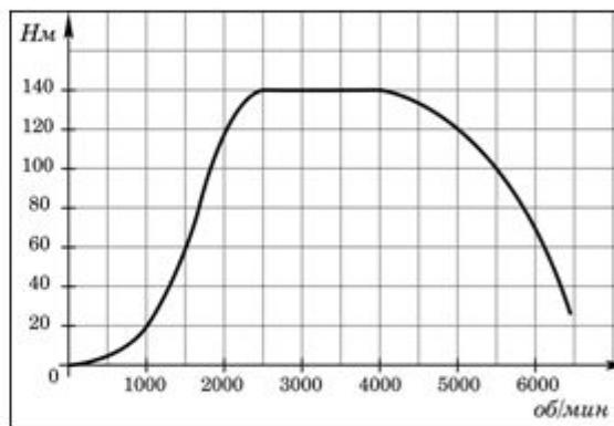
3. На графике изображена зависимость крутящего момента автомобильного двигателя от числа его оборотов в минуту. На оси абсцисс откладывается число оборотов в минуту. На оси ординат — крутящий момент в Н · м. Чтобы автомобиль начал движение, крутящий момент должен быть не менее 60 Н · м. Какое наименьшее число оборотов двигателя в минуту достаточно, чтобы автомобиль начал движение?
