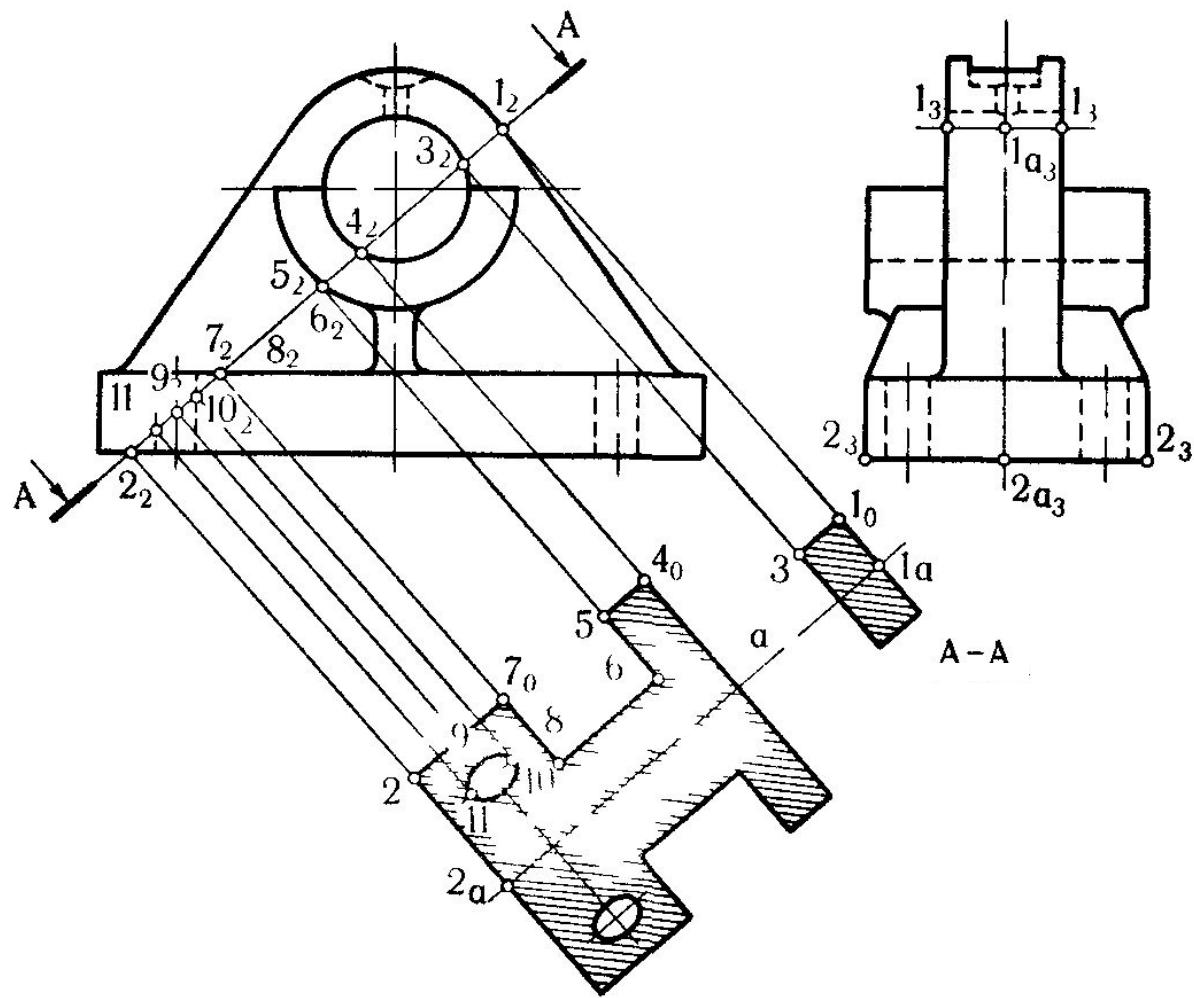
Технические детали, в основе которых лежат тела вращения, по конструктивным соображениям часто срезаны плоскостями, параллельными их осям. Образующаяся в результате пересечения поверхности тела с плоскостью линия называется линией среза.
