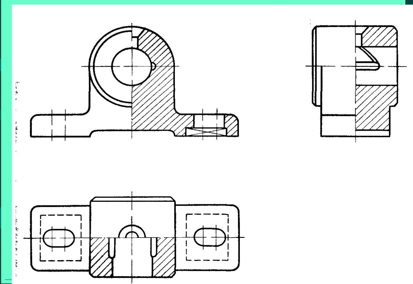
**Сечением называется условное изображение фигуры, получающейся при мысленном рассечении предмета плоскостью. В сечении показывается только то, что получается непосредственно в секущей плоскости.**
