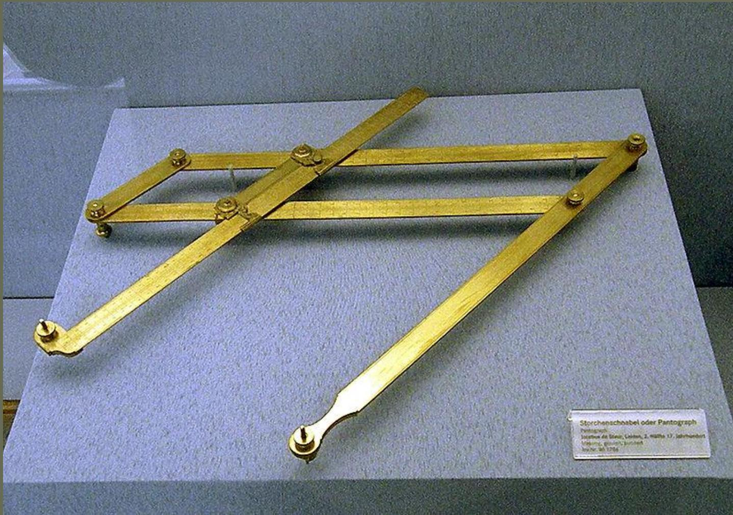
**ПАНТОГРАФ - ПРИБОР, СЛУЖАЩИЙ ДЛЯ ПЕРЕЧЕРЧИВАНИЯ ПЛАНОВ, КАРТ И Т. П. В ДРУГОМ, ОБЫЧНО БОЛЕЕ МЕЛКОМ МАСШТАБЕ. ПАНТОГРАФЫ ИЗГОТОВЛЯЮТ РАЗЛИЧНЫХ РАЗМЕРОВ И РАЗНЫХ КОНСТРУКЦИЙ (ПОДВЕСНЫЕ, НА КОЛЕСИКАХ И ДР.). ПОЗВОЛЯЮТ ОДНУ ИЗ ВЕРШИН ДВИГАТЬ ПО ПРЯМОЙ ЛИНИИ.**
