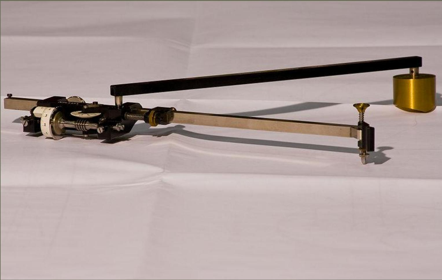
**Планиметр (механический интегратор) – это прибор, служащий для простого механического определения площадей (интегрирования) замкнутых контуров, прорисованных на плоской поверхности.**
