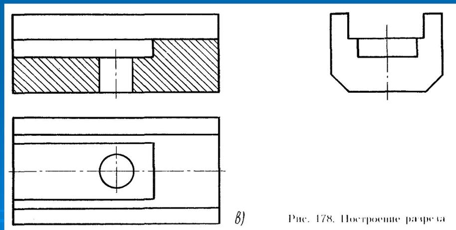
Рис. 178. Построение разреза
