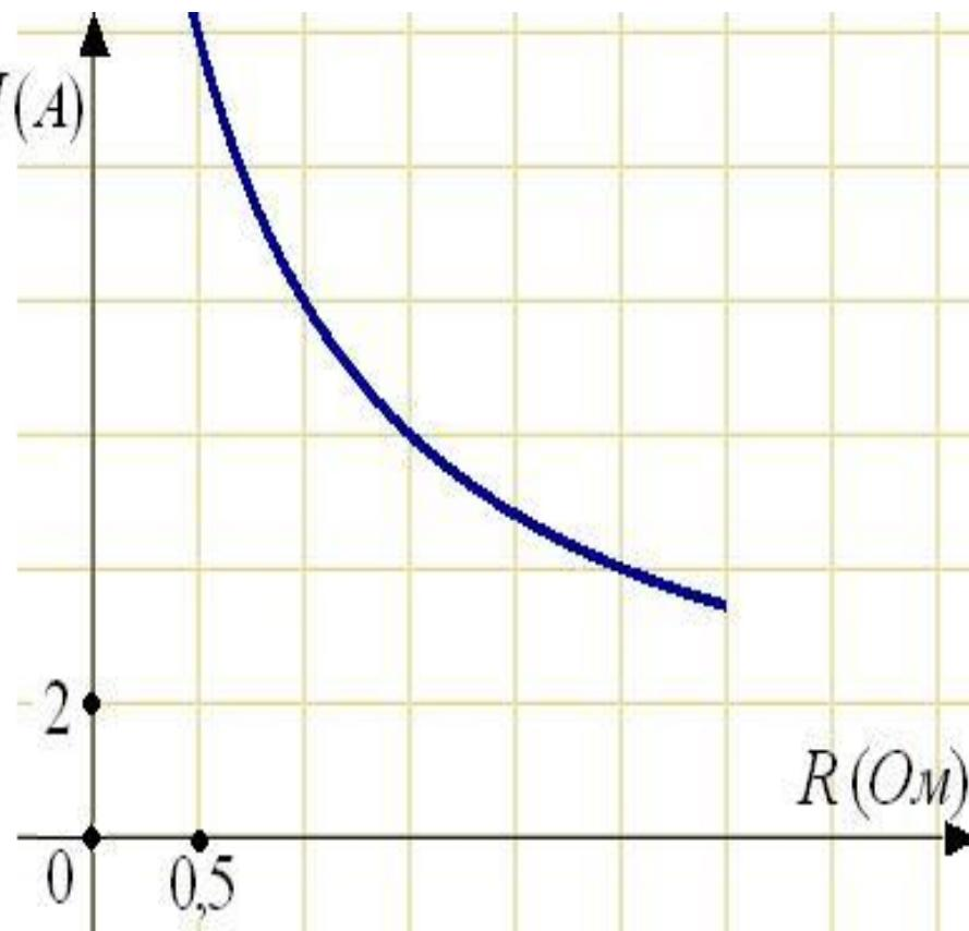
На рисунке показана зависимость силы тока от величины сопротивления. На оси абсцисс откладывается сопротивление (в Омах), на оси ординат – сила тока в Амперах. Сколько Ампер составляет сила тока в цепи при сопротивлении 1 Ом?
