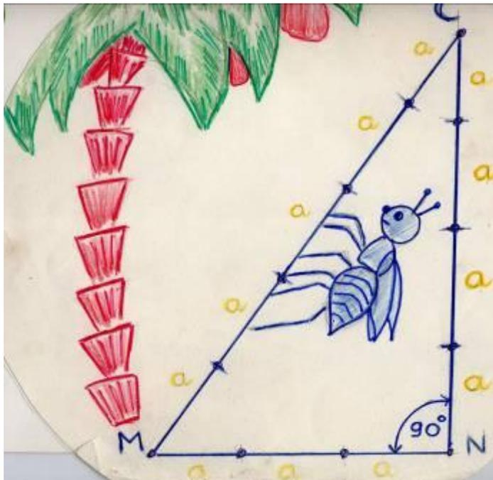
Землемеры Древнего Египта для построения прямого угла пользовались следующим приемом. Бечевку делили узлами на **12** равных частей и концы связывали. Затем бечевку растягивали на земле так, чтобы получался треугольник со сторонами **3, 4, 5**. Угол треугольника, противолежащий стороне с пятью делениями, был прямой. В связи с указанным способом построение прямого угла, треугольник со сторонами **3, 4, 5** иногда называют **египетским**
