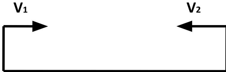
$$V_{\text{сбл.}} = V_1 + V_2$$
