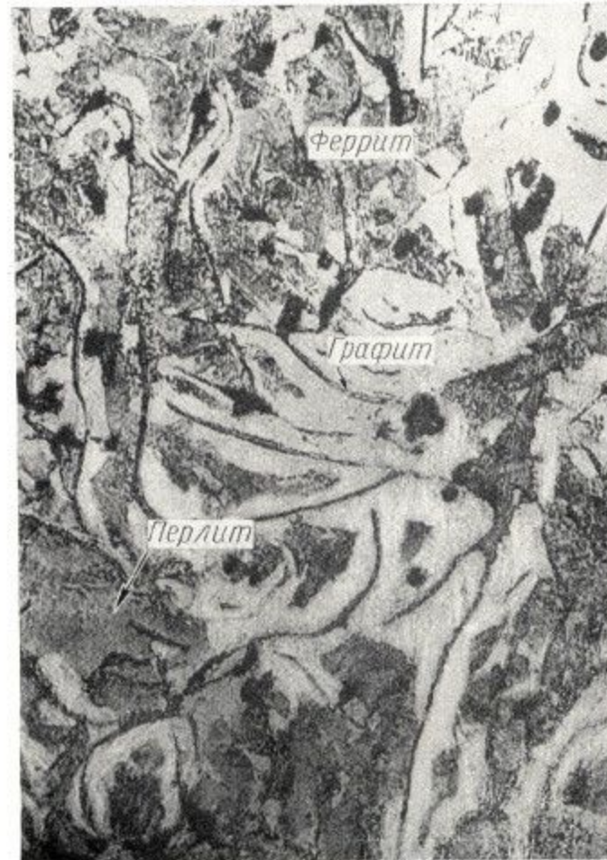
Фиг. 33. Серый чугун после травления: — а — перлитно-графитная микроструктура, отвечающая высокой твердости и износостойкости, \times 1000 ; б — перлитно-ферритно-графитная микроструктура, отвечающая пониженной твердости и износостойкости, \times 200 .
