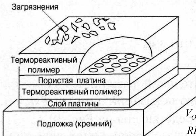
Конструкция емкостного датчика относительной влажности ННН-3610
